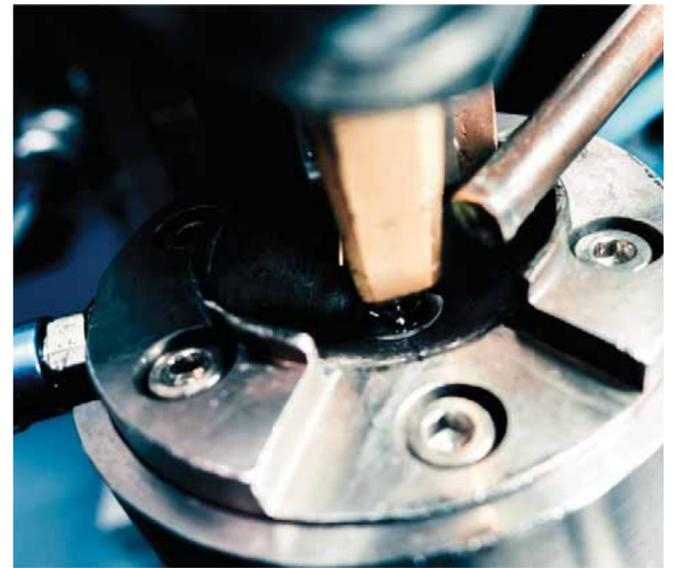
Feinarbeit: An die Spitze der Feder wird die kleine Kugel geschweißt, auf der geschrieben wird.
