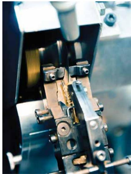
Goldener Schnitt: Die Feder wird mit einem Sägeblatt gespalten.
