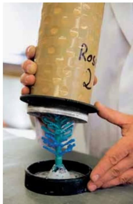
Die feuerfeste Küvette wird über den wächsernen Ringbaum gesetzt.
