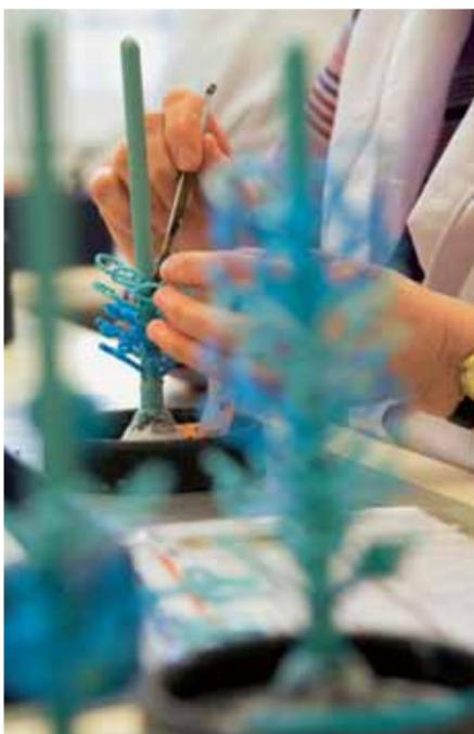
Mit den Modellen aus Spezialwachs wird ein Ringbaum aufgebaut.
