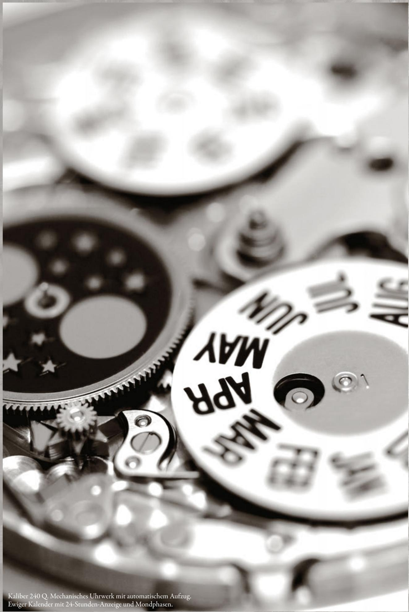
Kaliber 240 Q. Mechanisches Uhrwerk mit automatischem Aufzug.
