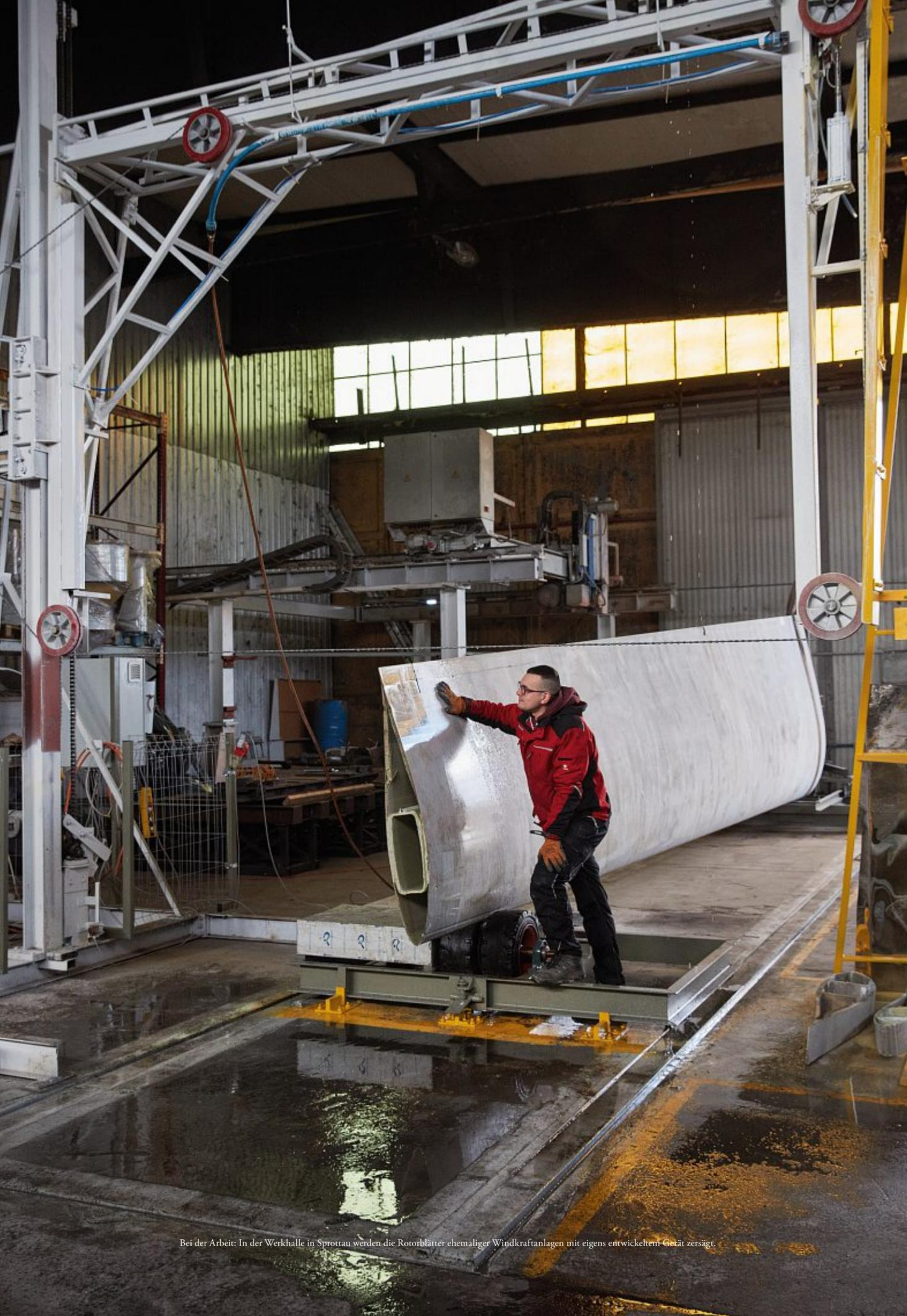
Bei der Arbeit: In der Werkhalle in Sprottau werden die Rotorblätter ehemaliger Windkraftanlagen mit eigens entwickeltem Gerät zersägt.
