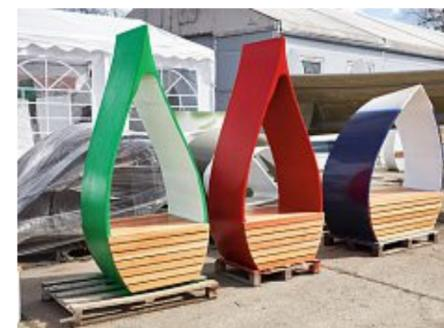
In Form gebracht: In die zersägten Teile der Rotorblätter (ganz oben) montieren die Arbeiter Sitz- und Liegeflächen aus Lärchenholz, die jeweils individuell angepasst werden müssen.
