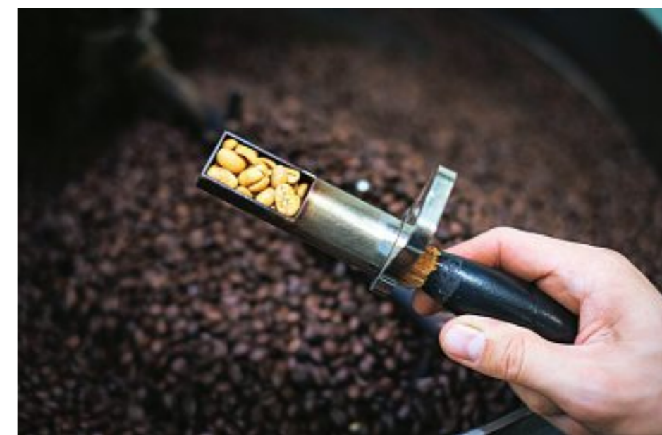
Handarbeit: Mit dem Probezieher wird der Stand der Röstung immer wieder kontrolliert.
