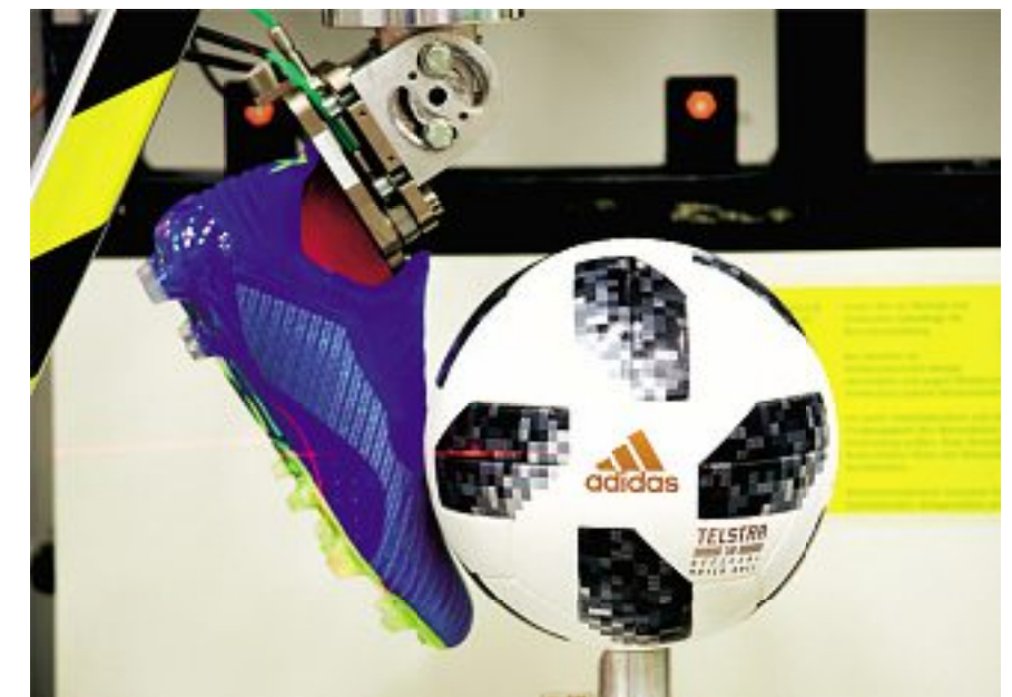
Schulstreck: Der „Telstar18“ wird mit der Ballschussmaschine auf Tempo 100 beschleunigt.
