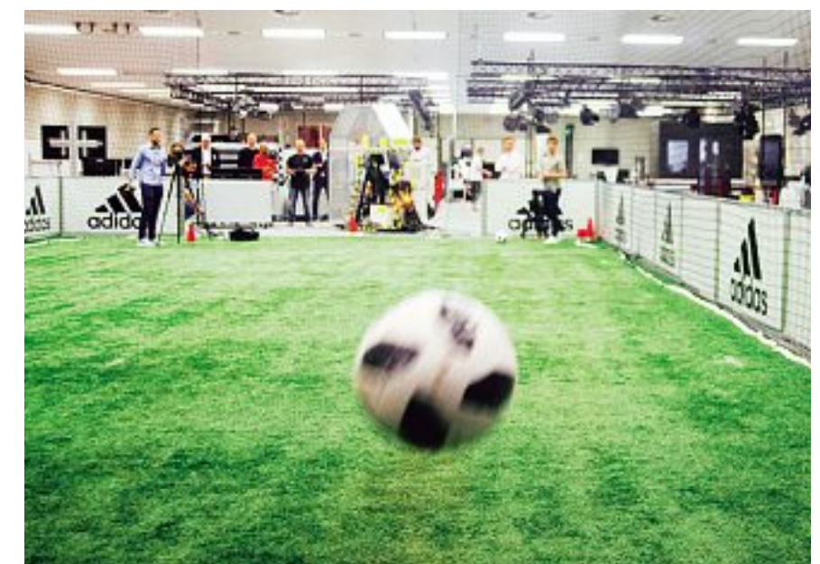
Luftbild: Die Schussmaschine liefert Daten über das Flugverhalten des Balls.
