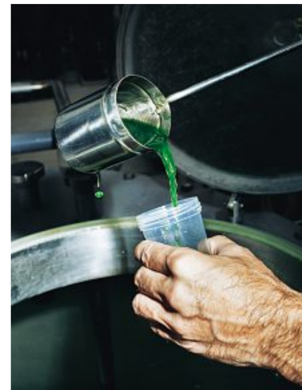
Abguss: Sind die Algen reif, wird das grüne Wasser aus den Röhren zentrifugiert. Der entstehende Schleim kommt in den Trockner.
