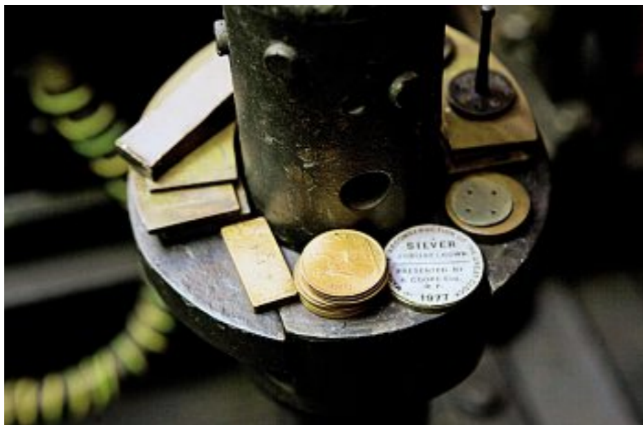
Gewichte für die Genauigkeit: Mit Münzen lassen sich Pendel und Uhr manipulieren.
