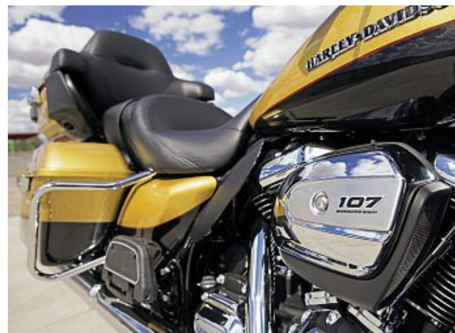
Alle Acht: Das neue Vierventil-Zweizylinder-Triebwerk der Electra Glide leistet 91 PS.
